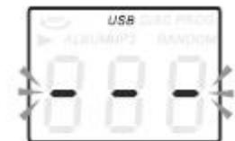
1. Appuyez d'abord sur CD/USB et sur FUNCTION pour entrer en mode USB. Le pictogramme « --- » et USB est indiqué.
