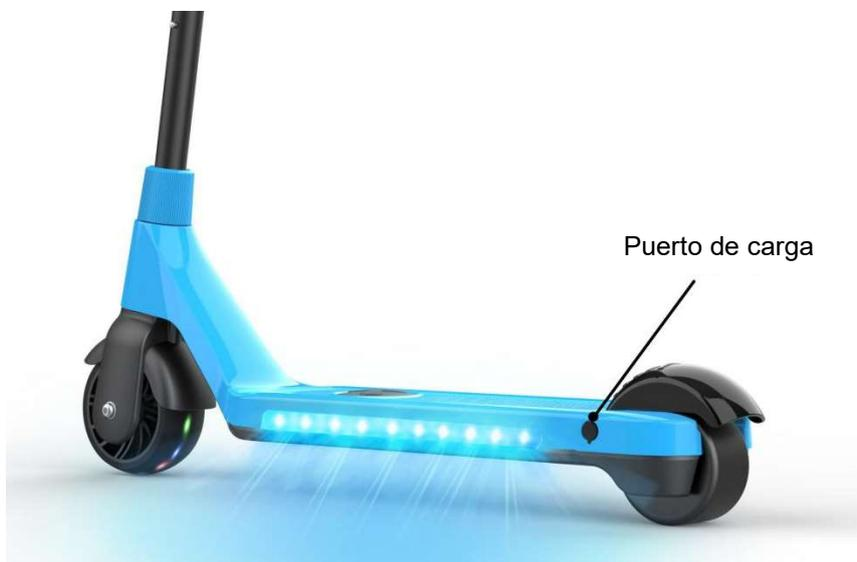
3. Conecte la entrada de alimentación del cargador a la toma de corriente.
