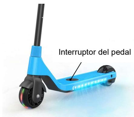
2. Empuje ligeramente hacia delante con el otro pie. Cuando alcance 3km/h el motor emitirá un PITIDO y se arrancará el motor.
