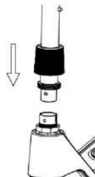
**2. Conecte el tubo vertical a la placa inferior y alinéelo con el tornillo**
