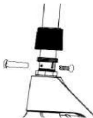
3. Bloccare la vite mediante un giravite
