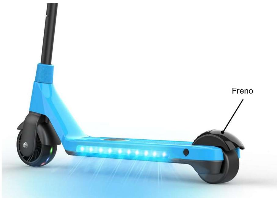
6. Se si desidera arrestarsi, utilizzare un piede per azionare il freno meccanico posteriore. Dopo aver udito il segnale acustico, continuare ad azionare il freno fino a quando il monopattino elettrico per bambini non si arresta.
