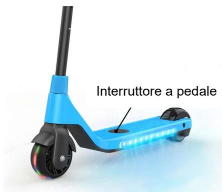
2. Spingere delicatamente in avanti con l'altro piede. Quando si raggiungono i 3 km/h il motore emette un segnale acustico e si avvia.
