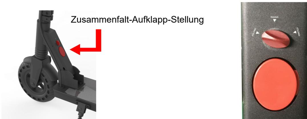
Drücken Sie den roten Knopf, um den Elektroroller aufzuklappen oder zusammenzufalten. Drehen Sie den Sicherungs-drehknopf auf die Stellung „FOLDING“ auf der linken oder rechten Seite und drücken Sie anschließend den roten Entriegelungs-knopf, um Ihren Elektroroller zusammenzufalten. Drehen Sie den Sicherungs-drehknopf auf die Stellung „RIDING“, um mit Ihrem Elektroroller zu fahren.
