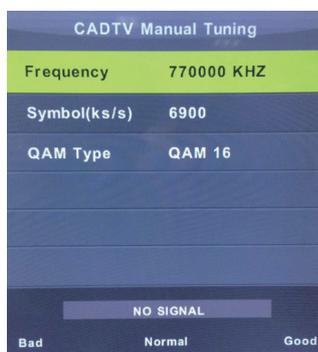
Accedere alla sintonizzazione manuale CADTV. Premere il pulsante ▲/▼ per selezionare gli articoli e premere il pulsante ◀/▶ per selezionare "Frequency", "Symbol", "QAM Type" e premere OK per la sintonizzazione manuale.
