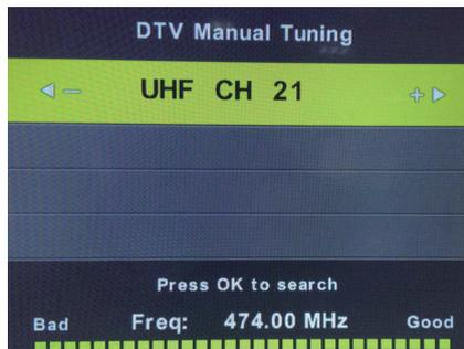
Accedere alla sintonizzazione manuale DTV. Premere il pulsante ◀/▶ per regolare il canale e premere il pulsante OK per la sintonizzazione manuale.
