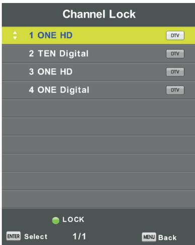
Pulse el botón ▼/▲ para seleccionar Channel Lock y, a continuación, pulse el botón OK para acceder al submenú y seleccionar los canales que desee bloquear.
