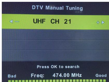
Entrar en sintonización manual DTV. Pulse el botón ◀/▶ para ajustar el canal y pulse el botón OK para sintonizarlo manualmente.
