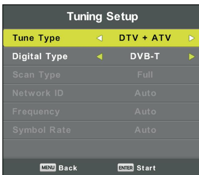
Seleccione DTV+ATV en “Tune Type”, y DVB-T en Tipo digital; posteriormente, pulse OK para iniciar la sintonización.
