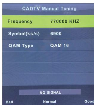
Entre en la sintonización manual CADTV. Pulse el botón ▲/▼ para seleccionar el elemento y pulse el botón ◀/▶ para ajustar la "Frequency", "Symbol", "QAM Type" y pulse el botón OK para la sintonización manual.
