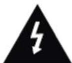
Der Blitz im gleichseitigen Dreieck weist auf Hochspannung im Gerät hin, die zu Stromschlag führen kann.
