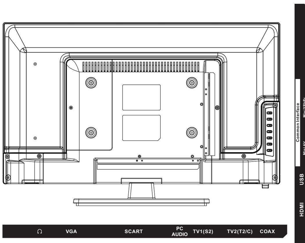
**VGA:** Zur Anzeige auf einem PC-Monitor. Verbinden Sie diesen Ausgang mit dem 15-poligen Sub-D Ausgang des PCs.
