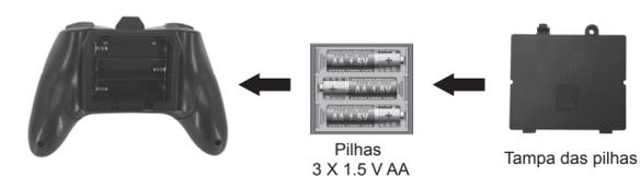
**Para instalar as pilhas:** Abrir a tampa do compartimento das pilhas, introduzir as 3 pilhas de 1,5 V AA de acordo com a polaridade indicada (pilhas não incluídas).
