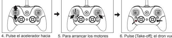
4. Pulse el acelerador hacia arriba y hacia abajo; sonará un pitido; el controlador se ha conectado al dron (Las luces LED del dron dejan de parpadear)
