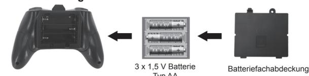
**Einlegen der Batterien:** Öffnen Sie die Abdeckung des Batteriefaches und legen Sie 3 1,5-V-Batterien des Typs AA entsprechend der angezeigten Polarität ein (Batterien nicht im Lieferumfang enthalten).
