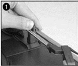
Verriegelung drücken, um Tonarm zu lösen.
