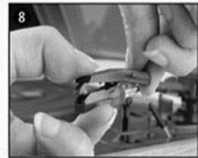
Installieren Sie die neue Nadel in umgekehrter Reihenfolge. Fügen Sie das Audiokabel entsprechend ein und installieren Sie den Nadelträger vorsichtig in der Halterung.
