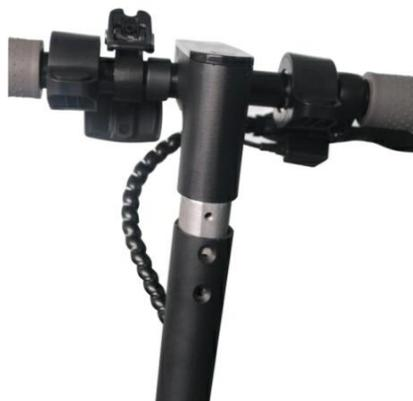
2). Une fois les trous du guidon sont alignés avec ceux du cadre, insérez les vis et les bien serrer ; répétez l'opération sur le côté opposé du guidon ; il y a 4 vis en tout.
